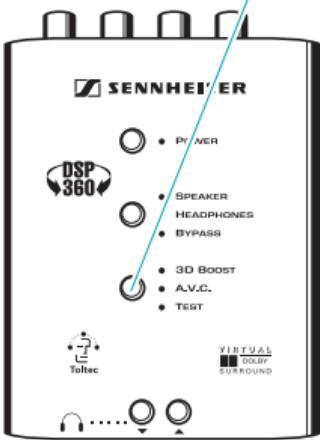
«TEST» Función de comprobación para verificar el correcto emplazamiento y la conexión correcta de su equipo.
